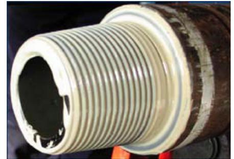
*Photo 4* Tube de forage après première rupture
