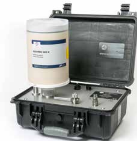
Kartridż serwisowy w użyciu (wkładany do mobilnej pompy)
