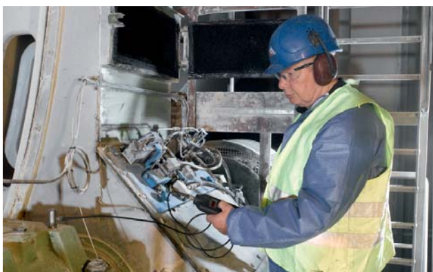
Вимірювання вібрацій підшипника підвінцевої шестерні
