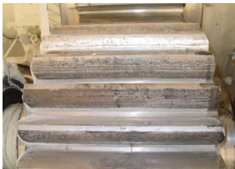
Порівняння пітингу до і після обробки
