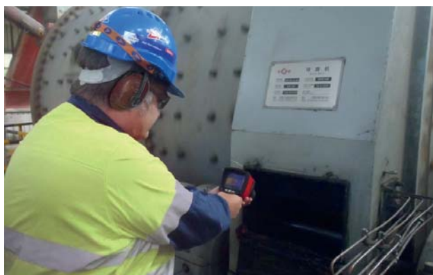
Динамічна перевірка з допомогою інфрачервоної відео-термографії
