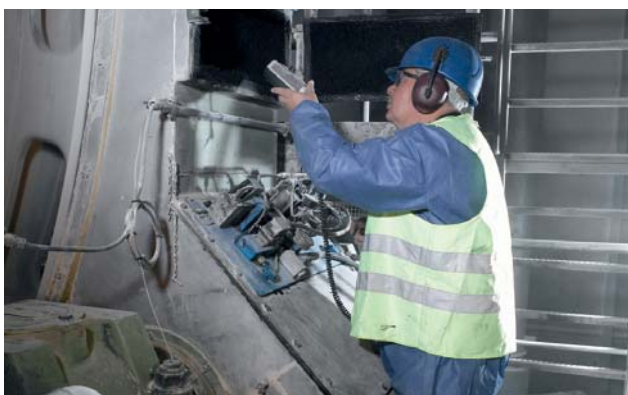
Динамічна перевірка площини контакту зубів з допомогою стробоскопу
