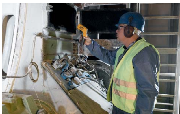
Вимірювання температури бокової поверхні зуба
