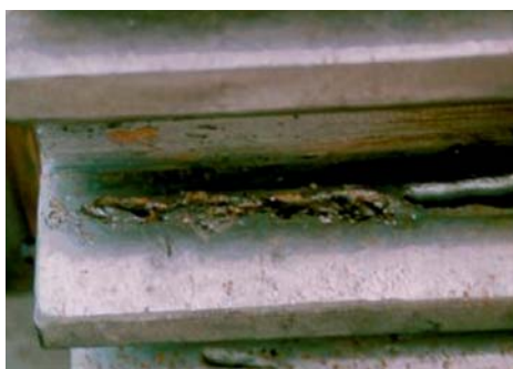
Порівняння пітингу до і після обробки
